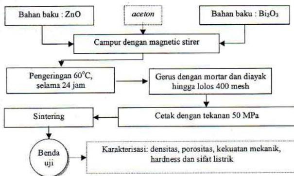
Gambar 2. Diagram Alir Preparasi Sampel Varistor  $ZnO$ .
